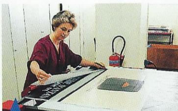
**2** Les bandeaux de repiquage au bas de certaines affiches Aribus sont placés à la main au moyen d'un adhésif double face spécial. Ces affiches sont ensuite roulées et baguées à l'aide de tables de roulage semi-automatiques.
