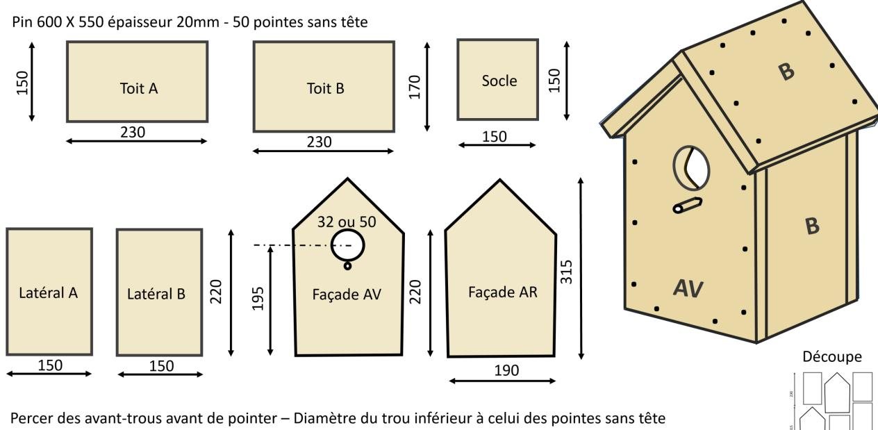
Percer des avant-trous avant de pointer – Diamètre du trou inférieur à celui des pointes sans têt Perchoir diamètre 6 mm Collage avant pointage et pour perchoir Finition : Peinture
